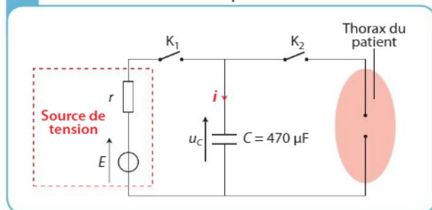
Avant d'appliquer le choc électrique au patient, la source de tension charge le condensateur. Le graphique ci-dessous représente la tension  $u_C$  aux bornes du condensateur au cours de cette charge en fonction du temps  $t$ .
