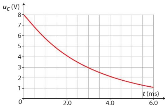
Lors de la décharge d'un condensateur, cette tension a pour expression  $u_C = K \times e^{-\frac{t}{R \times C}}$  où  $K$  est une constante d'intégration réelle.
