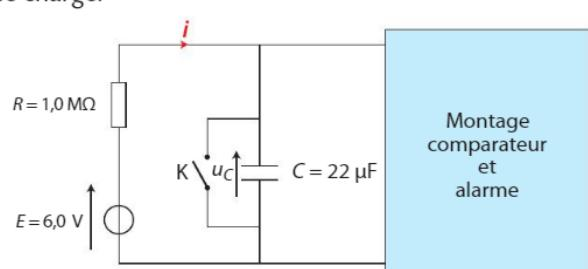
Le montage comparateur mesure la tension aux bornes du condensateur et la compare à une tension de référence  $u_{\text{ref}} = 5,0 \text{ V}$ . Aucun courant ne circule dans la branche de ce montage comparateur. L'alarme sonore se déclenche si  $u_C > u_{\text{ref}}$ .
