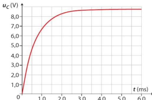
1. En considérant l'expression de la tension  $u_C$  d'une part, et la représentation graphique d'autre part, déterminer la force électromotrice  $E$  de la pile.
