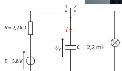
Lors de la prise d'une photographie avec flash, le condensateur emmagasine de l'énergie fournie par la batterie pendant quelques secondes, puis la restitue dans une lampe en 0,1 s. La lampe L émet alors un éclair lumineux intense.
